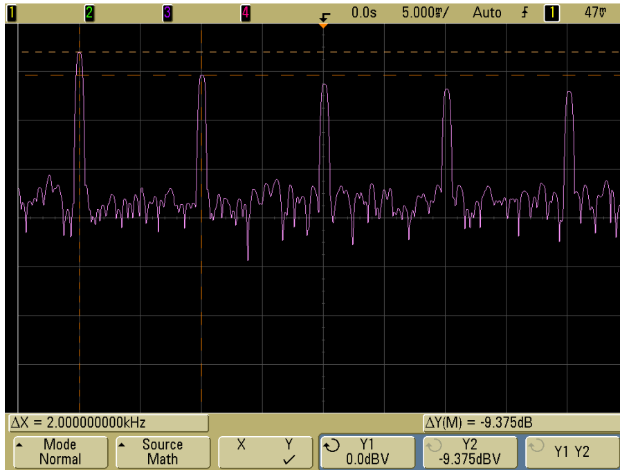
Abbildung 7: Rechtecksignal im Frequenzbereich
