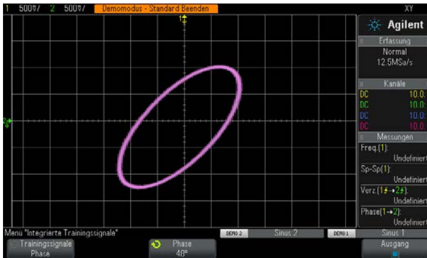
Lissajous-Figur, die im XY-Mode erzeugt wurde
